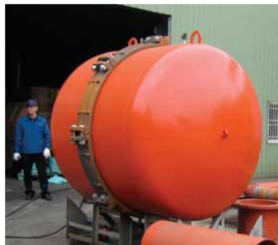
Prueba hidrostática - 72" R-88 de acoplamiento
