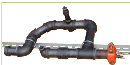
Prueba de Ruptura de los accesorios roscados Hierro Dúctil (2")
